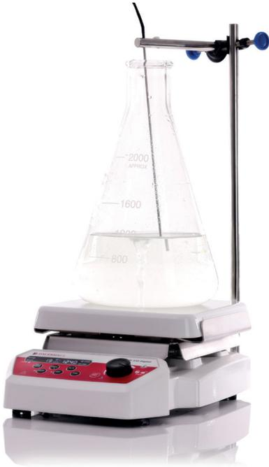
El agitador magnético MAG D-550 digital está diseñado para crear mezclas homogéneas y/o acelerar reacciones. Puede trabajar con soluciones de distintas viscosidades con precisión, con una velocidad que va de 200 a 2200 RPM.
